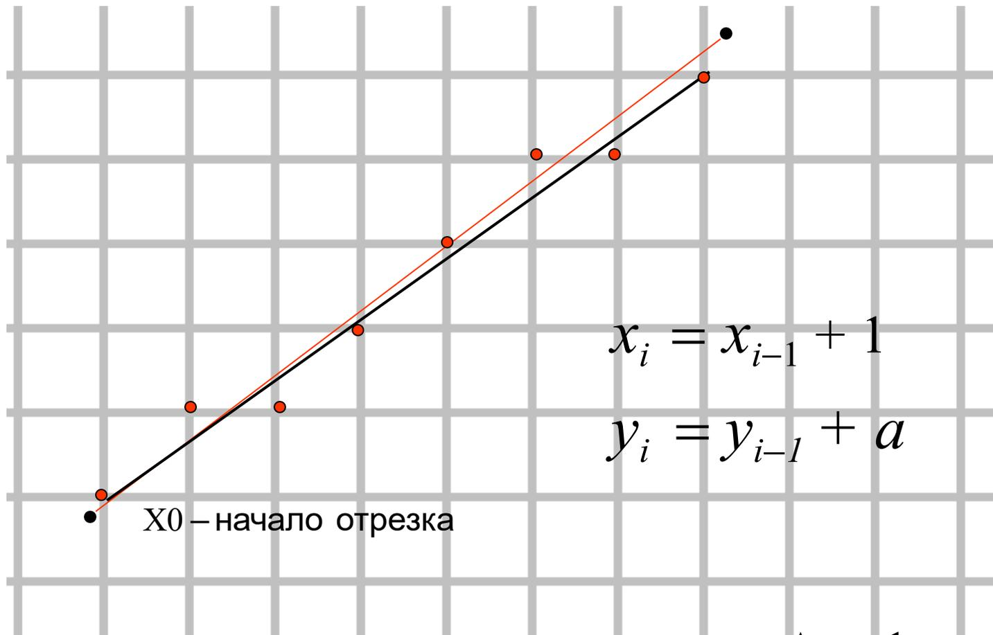
Делаем пересчет в растровую систему координат  $\Delta x = 1$
