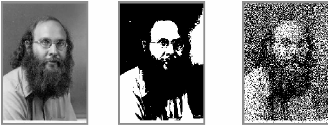
Рис. 6.10. Слева: исходное изображение, палитра 0-255, 8 бит. Середина: равномерное квантование, палитра: 0 и 1. Справа: с применением шума СДЕЛАТЬ РАНД ДЛЯ ЛЕНЫ
